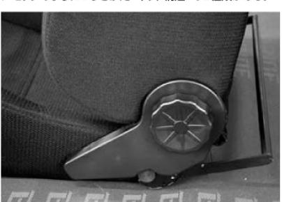
リクライニングアジャスターは、段階的に調整するレバータイプで、ダイヤルで無段階調整可能な細かい調整機能を備えたものもある。
