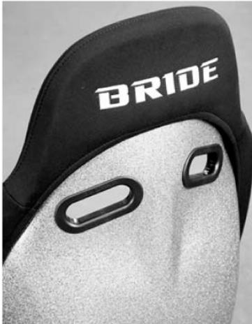
プリッドのフルバケットシートの側面には、調整穴が複数用意されているものも。これらのボルト位置やステーの固定穴の位置の組み合わせで、ステアリングとの距離などを調整することができる。バックレストのリクライニング機構がないフルバケにとって、ドライビングポジションを調整するための重要な部分だ。
