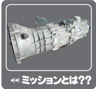
エンジン、効率よくパワーやトルクを發揮できる回転数域が決まっているうえに、どこまでも回転があがっていくわけではなく、レブリミットという上限もある。そこで、エンジンの回転とタイヤに伝わる回転を、ギヤ比を切り替えるなどして、低速から高速まで対応できるように調整する役割をするのがミッションだ。
