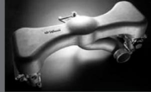
東名パワードが開発したEJ20エンジンの4連スロットル。純正ではシングルスロットルのEJ20を4連スロットル化することで、レスポンスアップをはかる。また、大容量サージタンクがセットされることで高回転、高出力時に効果を発揮する。
