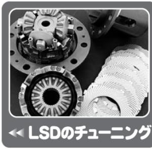
プレッシャーリングとデフケースのあいだにあるクラッチプレートが圧着され、圧着されたプレッシャーリングは、デフケースに連動して回転するようになる。これで、プレッシャープレートにつながっている左右のタイヤは、ドライブシャフトに合わせて回転しているデフケースとおなじ回転をするようになるんだ。
