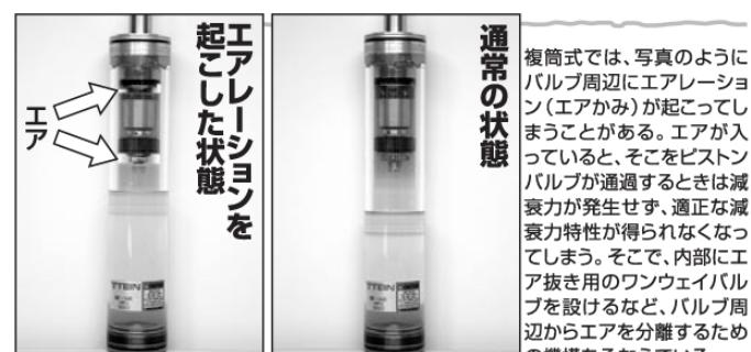
複筒式では、写真のようにバルブ周辺にエアレーション（エアカム）が起こってしまることがある。エアが入っていると、そこをピストンバルブが通過するときは減衰力が発生せず、適正な減衰力特性が得られなくなってしまう。そこで、内部にエア抜き用のワンウェイバルブを設けるなど、バルブ周辺からエアを分離するための機構をそなえている。
